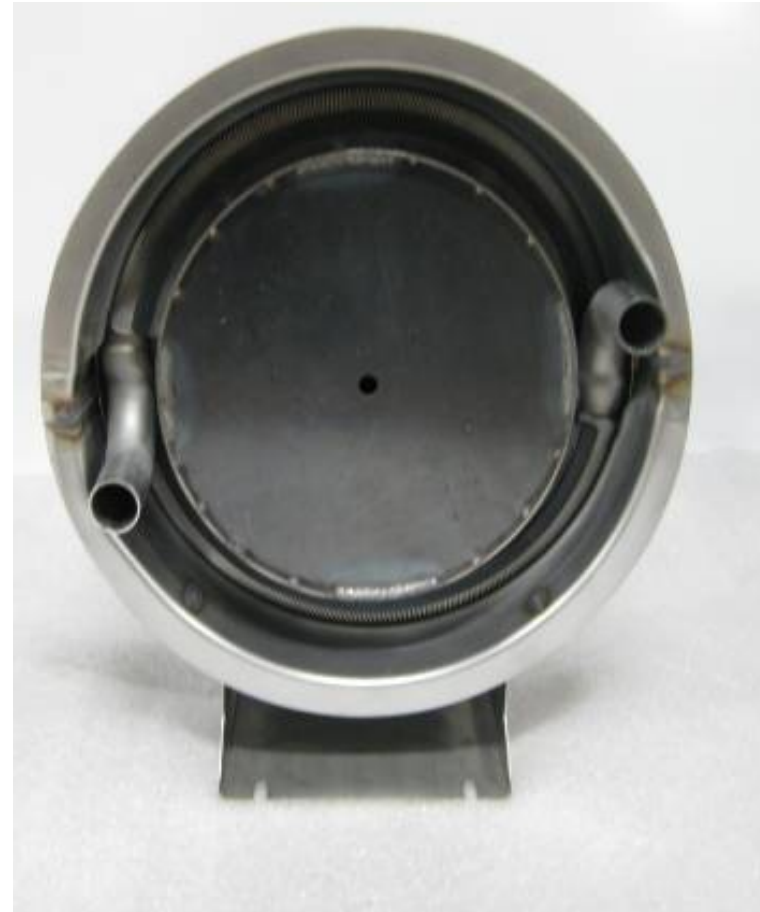
Собранный низ теплообменника (с установленным дивертером)
