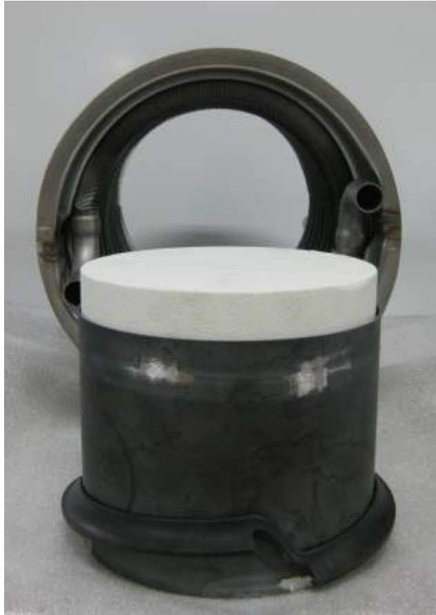
Дивертер отходящих газов с изолирующей вставкой
